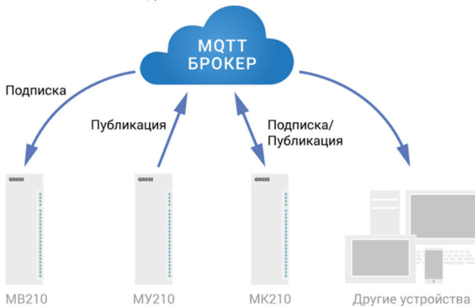
Рисунок 6.2 – Структурная схема обмена по протоколу MQTT
